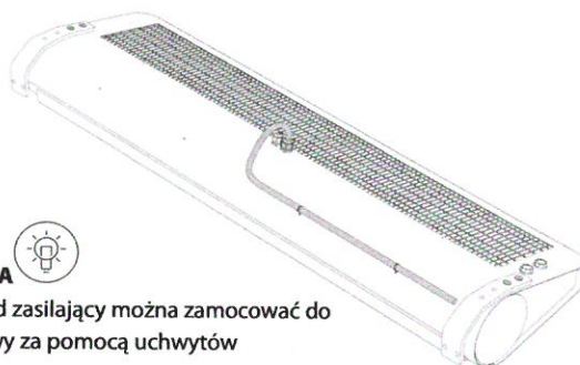
RYS. 11.6 PROWADZENIE PRZEWODU PO OBUDOWIE.
