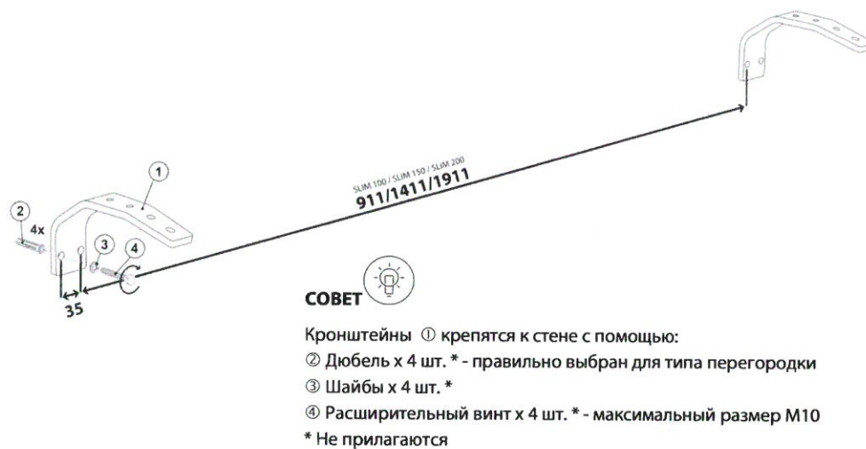
РИС. 10.1 РАССТОЯНИЯ МЕЖДУ МОНТАЖНЫМИ КОНСОЛЯМИ.
