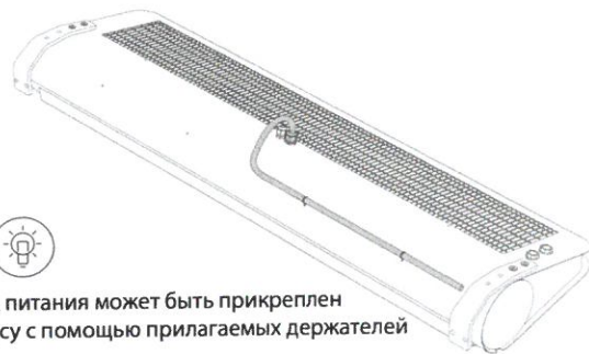
РИС. 11.6 ПРОКЛАДКА КАБЕЛЯ ВОКРУГ КОРПУСА
